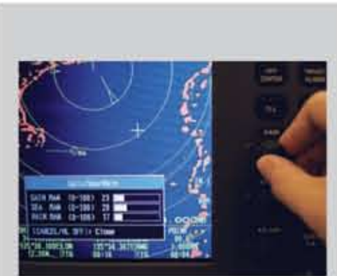
Специальные поворотные переключатели, регулирующие функции GAIN/STC/FTC для эффективной работы.
