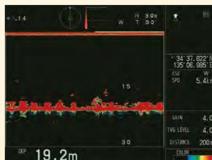
Чем ярче цвет отображаемого эхосигнала, тем сильнее сам эхосигнал. Поскольку мощность эхосигнала хорошо видна, становится проще понять характер этого сигнала.
