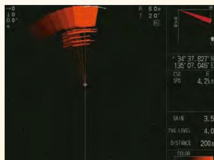
Будучи полностью выдвинутым, наклоненный в вертикальной плоскости датчик помогает установить местоположение косяков рыбы и морского дна непосредственно под судном при высоких скоростях его хода. Режим вертикального сканирования позволяет изобразить профиль дна в заданной пользователем вертикальной плоскости в любом направлении.
